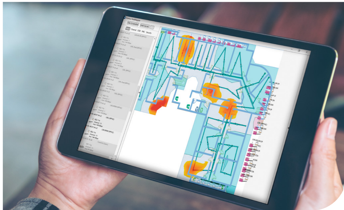
Abb. 2: Beispielansicht einer (groben) Ausleuchtung, hier mit einer kostenlosen »Homeuser«-Software: je tiefer das Blau, desto stärker das Signal; je stärker das Rot, desto schwächer das Signal. Die Accesspoints in Reichweite werden mit Informationen zu Funkstandard, Sendekanal und maximaler Datenrate aufgelistet.
